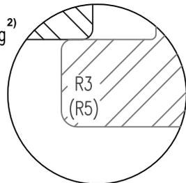
Glasleiste profiliert für Glasstärken 34mm bis 44mm
