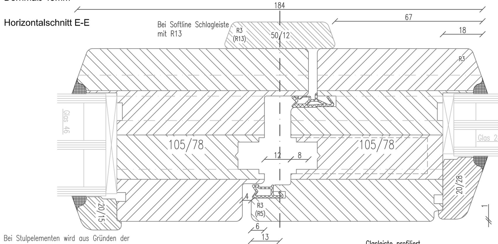
Bei Stulpelementen wird aus Gründen der Beschlagsmontage immer Schwelle MFT-101727206 verwendet; s. Zeichnung-Nr. 01-IV78-SC/08
