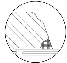
Bei Stulpelementen wird aus Gründen der Beschlagsmontage immer Schwelle MFT-101727206 verwendet; s. Zeichnung-Nr. 01-IV78-SC/08
